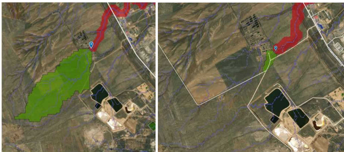
Рисунок 8.4: Гидрологический водосборный бассейн для существующей водоочистной станции (слева) и нового предлагаемого участка (справа) отмечен зеленым цветом. Красным отмечен путь потока вниз по течению.
