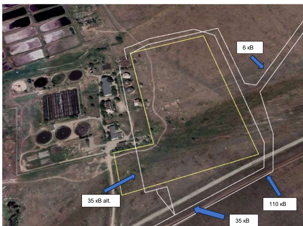
Рис. 3.7 Предлагаемое перемещение воздушных линий электропередач
